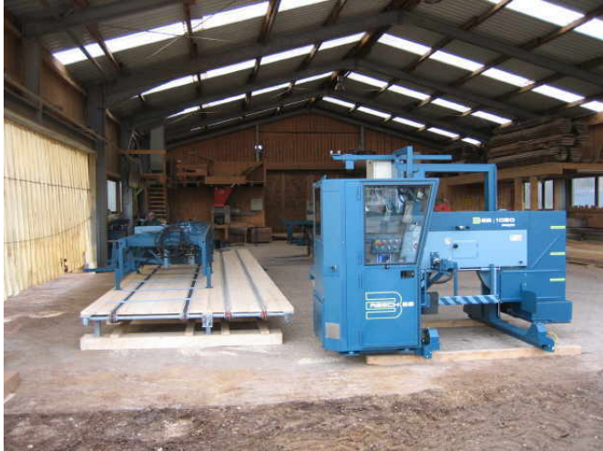
Bild 2: Aufbau der neuen stationären Blockbandsäge, Typ Resch ES 1050 Profi
